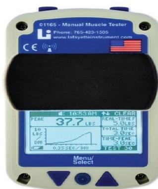
Imagem 2: Dinamômetro manual digital
