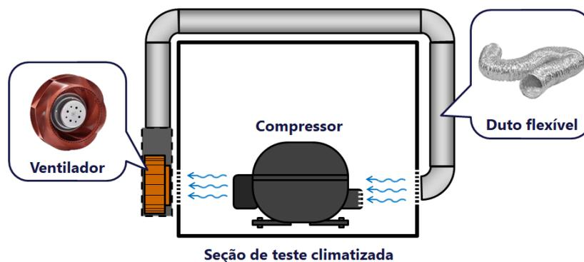
Figura 3 - Representação esquemática da ventilação da seção de teste.
