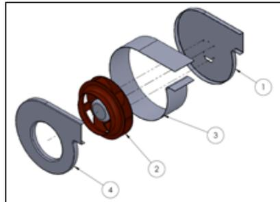
Figura 4 - Representação esquemática da ventilação da seção de teste.
