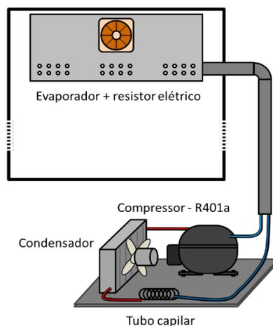
Figura 5 - Representação esquemática do circuito de refrigeração auxiliar.
