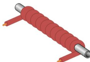
Figura 8 - Representação do resistor elétrico envolto ao tubo.
