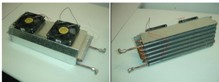
Figura 9 - Trocador de calor.
