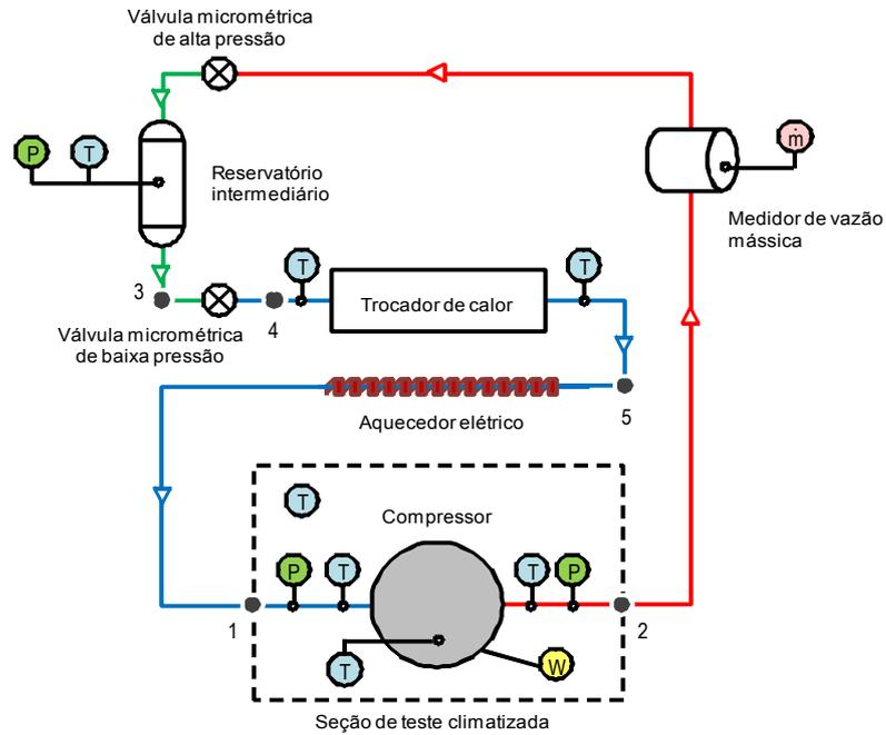
Figura 2 - Desenho esquemático do circuito de refrigeração principal.
