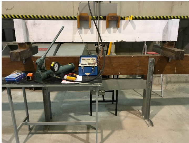
Figura 3 – Configuração do ensaio da viga
