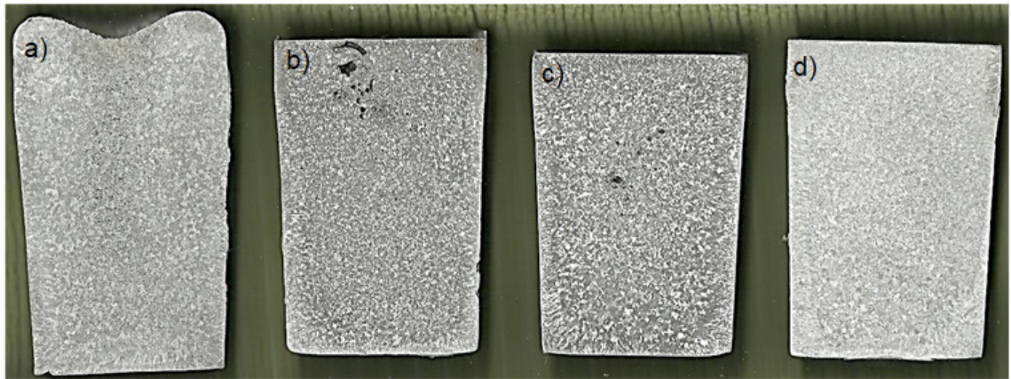
Figura 5 - Macroestrutura da Liga Al-9%Si com T_v = 700^\circ \text{C} . a) Pressão Atmosférica, b) 50MPa, c) 100Mpa, d) 150MPa.
