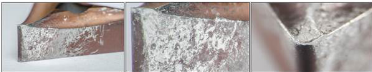
Figura 2 – Pastilha 1 revestida com Albonit (AlTiCN), depois dos testes
