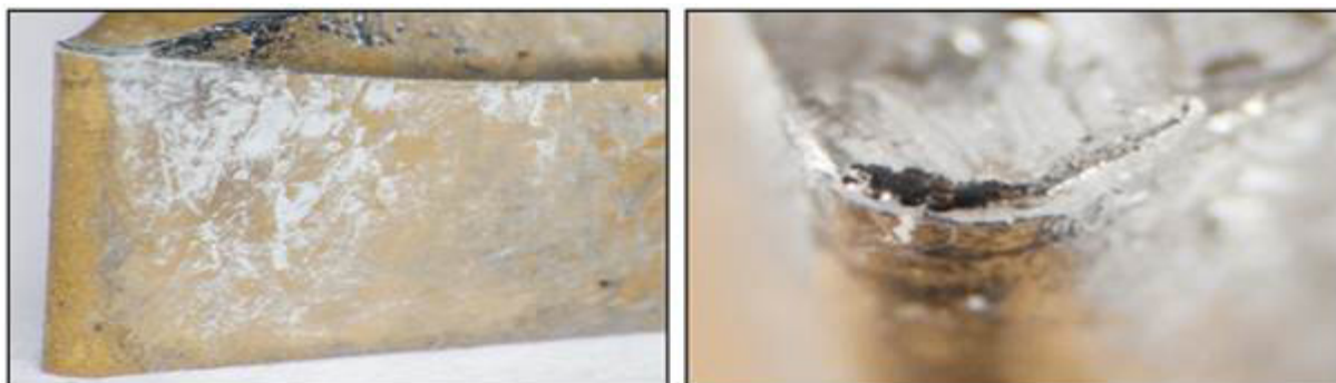
Figura 4 - Pastilha 3 revestida com Nitreto de Titânio (TiN), depois dos testes
