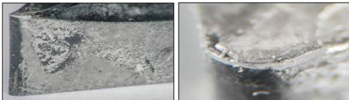
Figura 5 – Pastilha 4 sem revestimento, depois dos testes
