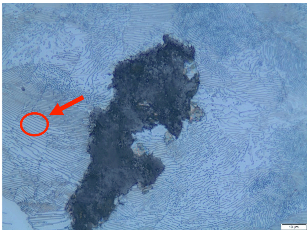
Figura 8. Vista bidimensional da matriz perlítica do material. (VIEIRA, L. E. R., 2018)
