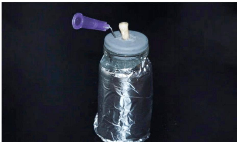
Figura 5-B - Conjunto com a folha de alumínio para instrumentação sem visualização pelo operador.
