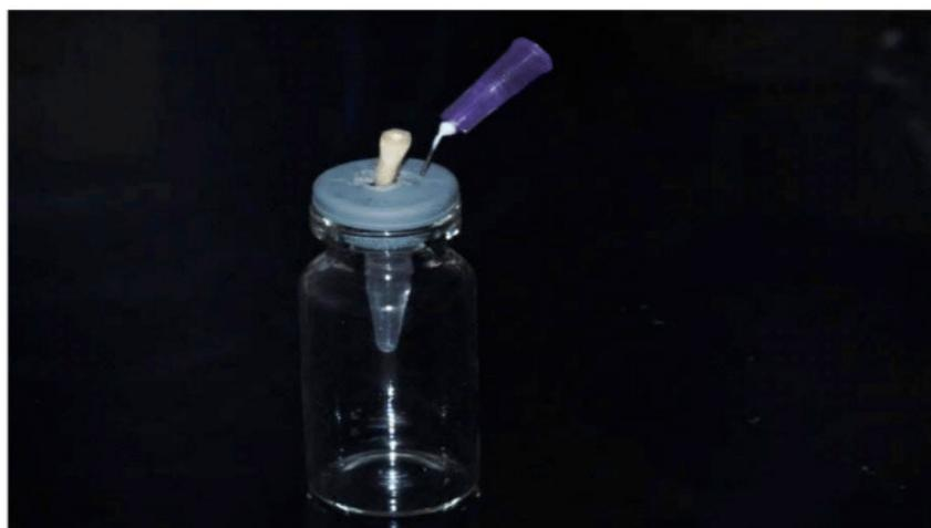
Figura 5-A –Conjunto com amostra posicionada no orifício feito na tampa do Eppendorf.
