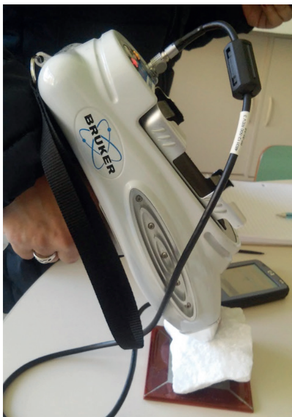
Figura 1: amostra de calcário sendo analisada em espectrômetro de fluorescência de raios-X
