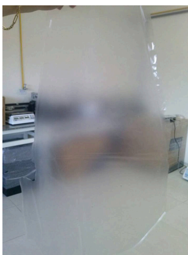
Figura 4. Filmes de amido obtidos pelo método ' tape-casting '.
