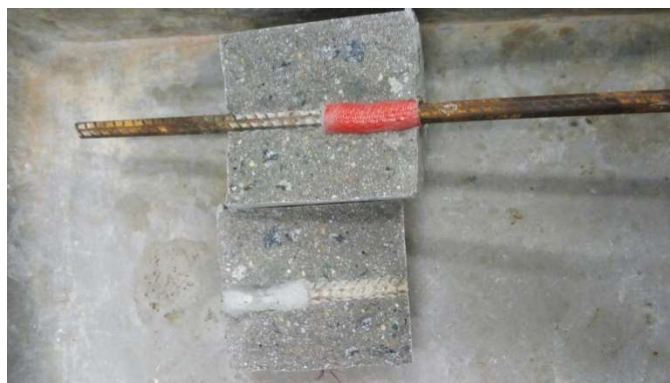
Figura 10 - Ruptura do corpo de prova de concreto auto adensável Fonte: Autora, 2016.
