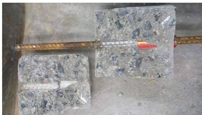
Figura 11 - Ruptura do corpo de prova de concreto alto desempenho Fonte: Autora, 2016.
