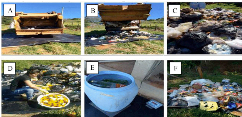
Figura 2 – Análise gravimétrica do RSU: A, B – descarregamento; D e E – separação e quantificação; C e F – homogeneização do RSU.
