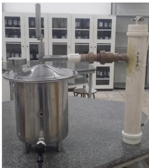
Figura 2 – Sistema de biodigestão anaeróbia
