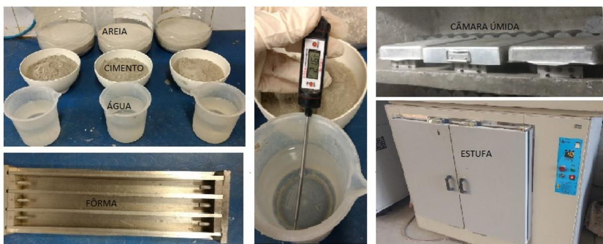
Figura 3– Materiais usados do ensaio acelerado
