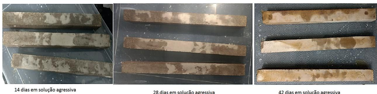
Figura 5 – Degradação por sulfato de magnésio
