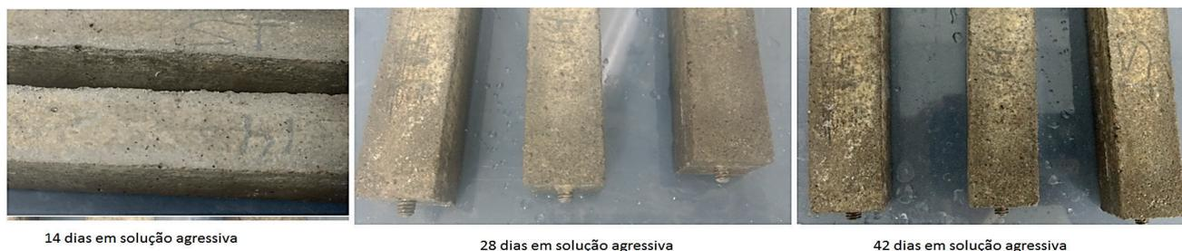
Figura 4– Degradação por sulfato de sódio
