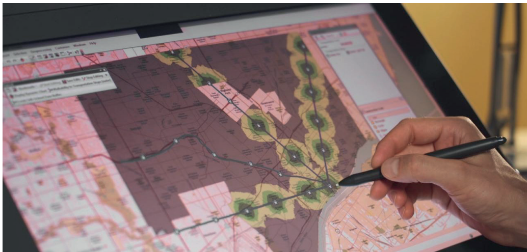
Figura 2 - Processo de vetorização com Mesa Digitalizadora de 23' de forma interativa direta e com caneta.
