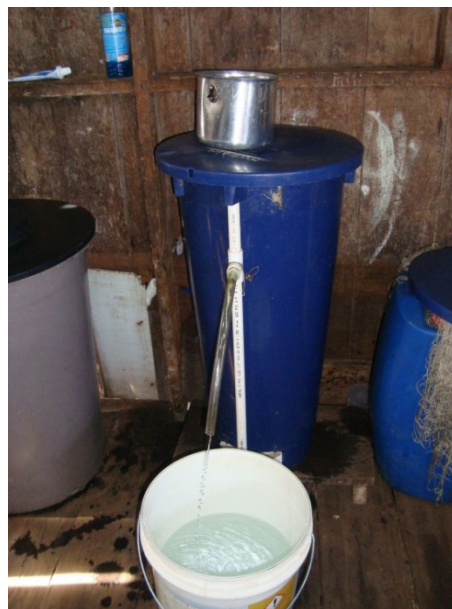
Figura 6. Filtro com sistema de filtração por areia
