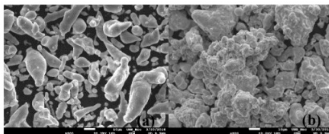
Figura 11. Análise do MEV do pó de alumínio (a) e cobre (b).
