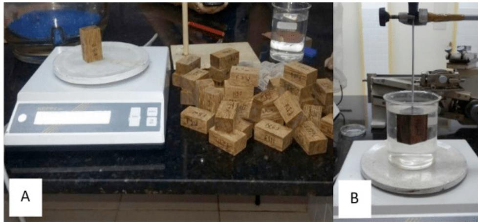
**Figura 1** – Procedimentos. A) Pesagem do corpo de prova de Acapú na balança eletrônica; B) Método de imersão baseado no princípio de Arquimedes.
