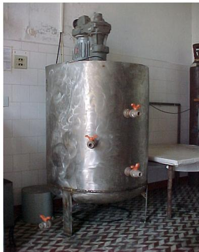
Figura 6. Vista parcial do reator biológico, com capacidade de 500L
