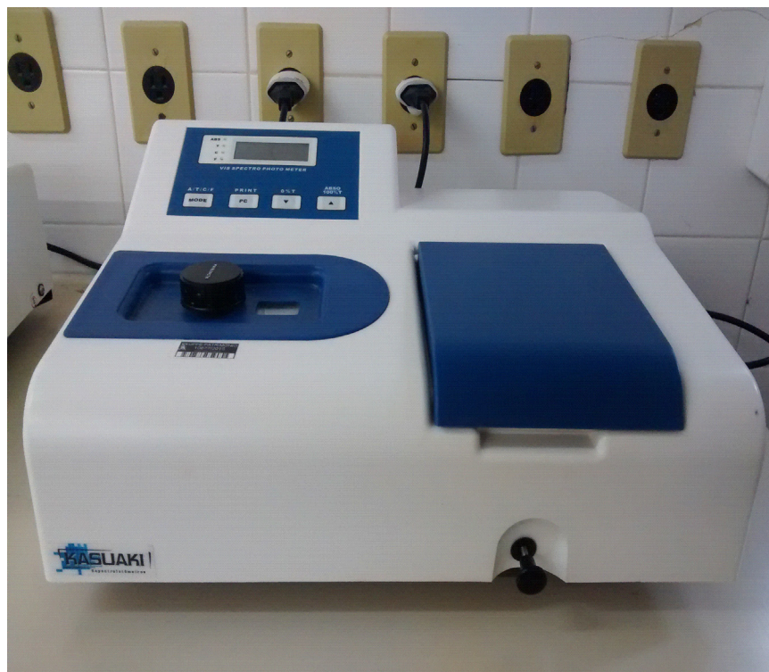
Figura 1: Vista externa do espectrofotômetro, marca Kasuaki®, modelo IL-226.
