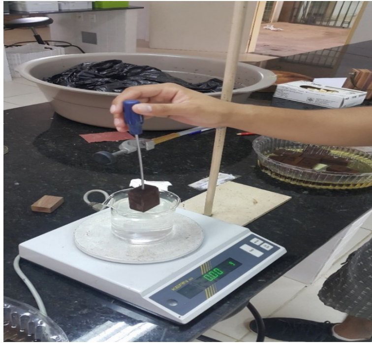
Figura 2 - Medição de volume pelo método da balança hidrostática
