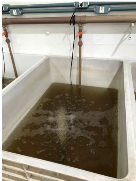
Figura 2. Estrutura experimental em caixa de polietileno para cultivo em bioflocos
