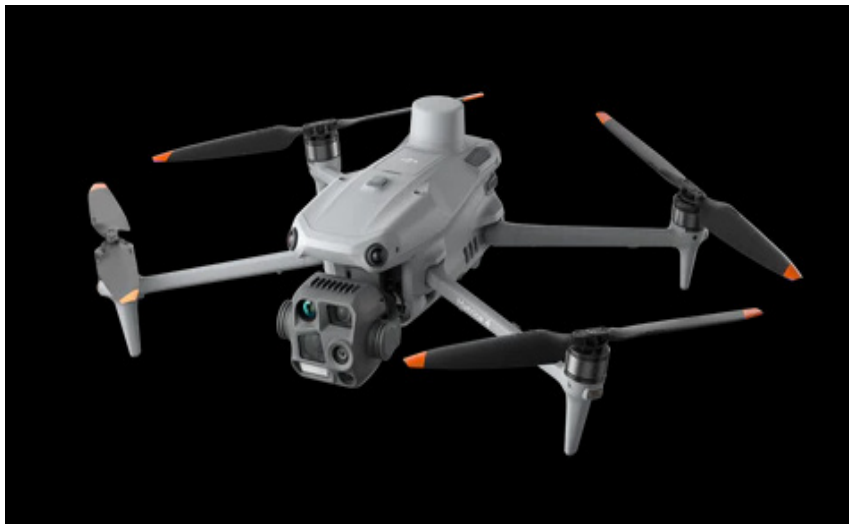
Figura 2 – Drone carenado, veículo aéreo não tripulado (VANT) multirrotor de padrão comercial, equipado com sistema de captura de imagens estabilizado, utilizado em inspeções aéreas urbanas.
