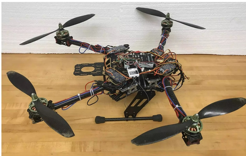
Figura 1- Drone aberto: veículo aéreo não tripulado (VANT) multirrotor do tipo quadricóptero, empregado em inspeções visuais urbanas exploratórias.
