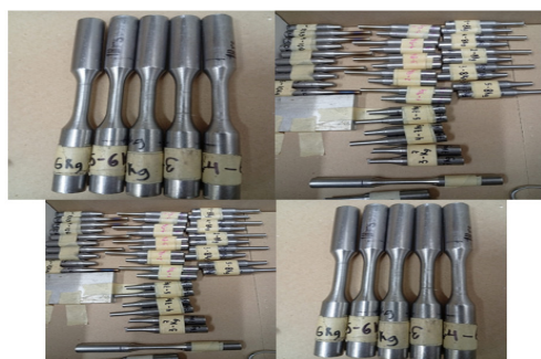
Figura 4. Serie de 5 probetas sin romper con las 4 series fracturadas.
