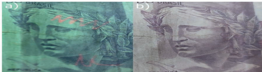
Figura 8: Cédula de R$ 5,00 contendo marcações realizadas com a caneta à base de \text{EuBDC}_{\text{PVP}} (a) sob irradiação de luz UV (254 nm), evidenciando emissão vermelha intensa, e (b) sob iluminação ambiente, na qual as marcações permanecem completamente invisíveis.
