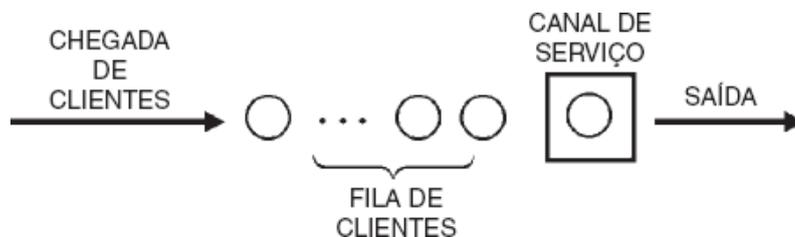
Figura 1: Sistema de uma fila e um canal
