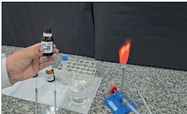
Figura 11. Teste de chama dos sais de cloreto de cálcio (a) e cloreto de sódio (b)
