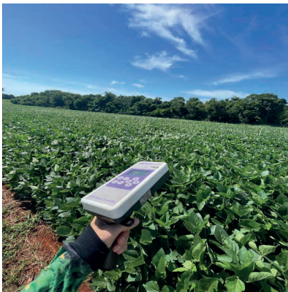
Figura 5. Equipamento utilizado para o sensoriamento remoto proximal, realizado por meio do sensor óptico ativo, modelo CS-45.
