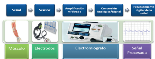
Figura 5. Modelo a bloques del sistema de adquisición de las señales mioeléctricas. Fuente: Elaboración propia.
