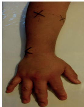
Figura 6. Selección de puntos estratégicos para adquisición de señales mioeléctricas. Fuente: Elaboración propia.
