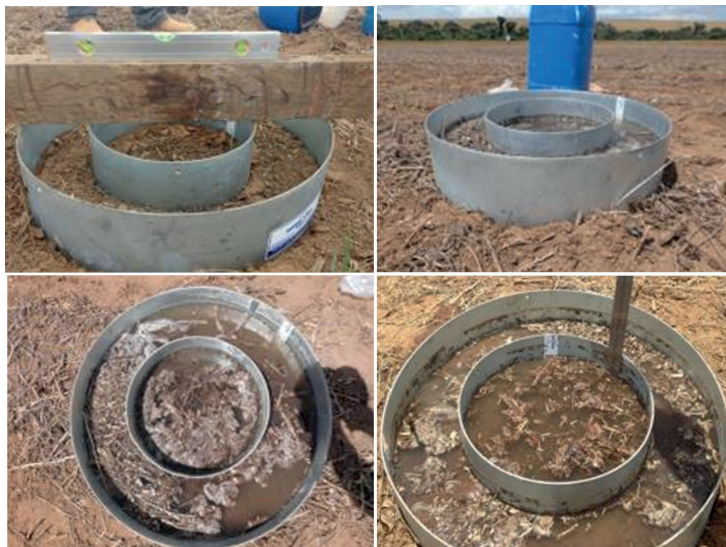
Figura 1. Representação do teste de infiltração de água no solo utilizando anéis concêntricos. Fonte: Jesuz e Ferreira, 2022.
