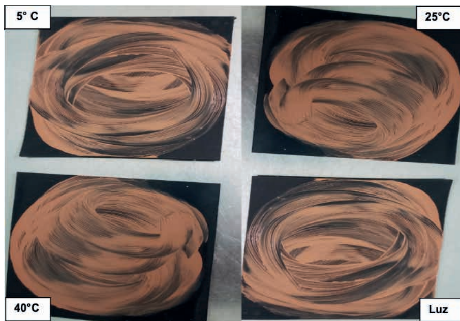
Foto 18. Resultados do teste de deslizamento em t90 da formulação E.
