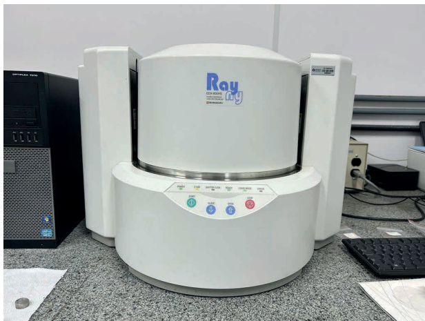
Figura 4. Espectrômetro de fluorescência de energia dispersiva de raios-X série EDX da Shimadzu – 800HS realizando os ensaios. Fonte: autora.
