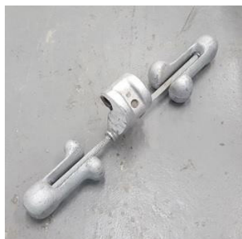
FIGURA 2. Stockbridge assimétrico utilizado nos ensaios.
