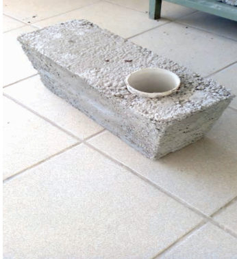
Figura 1: Prototipo de block para tubo radio conductor de energía solar
