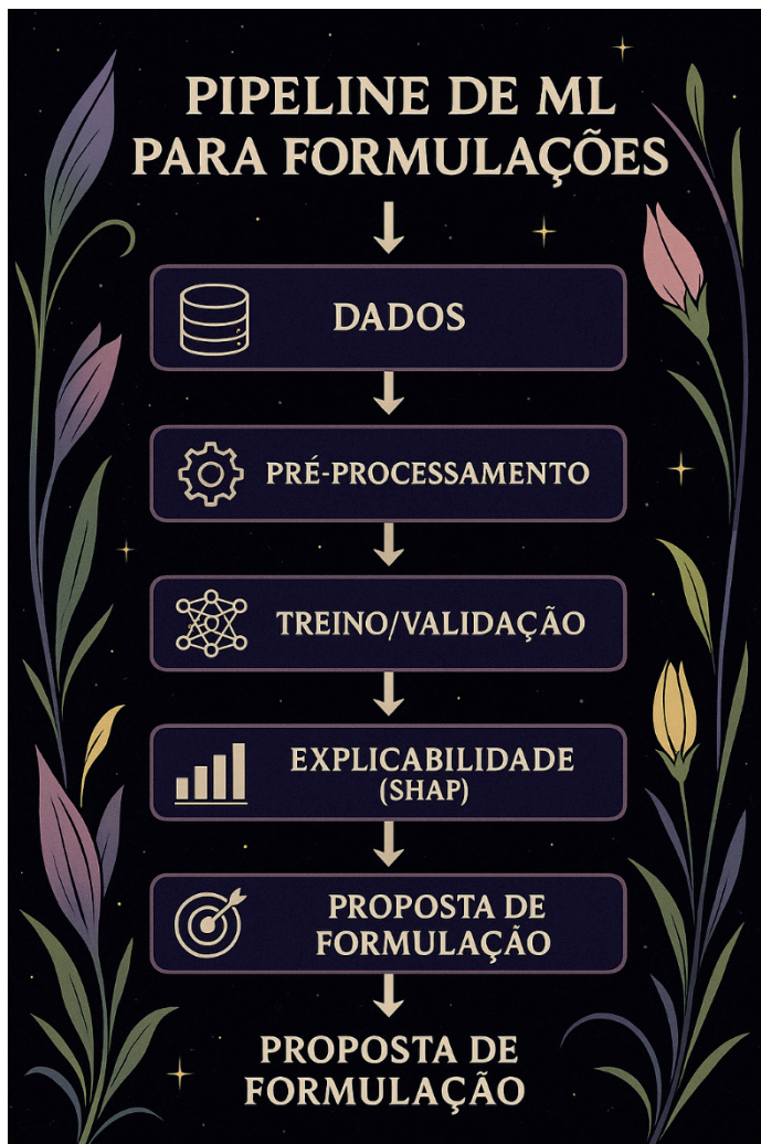
Figura 4: Pipeline de aprendizado de máquina aplicado ao design de formulações: dados → pré-processamento (limpeza, padronização e engenharia de variáveis) → treino/validação de modelos → explicabilidade (SHAP) para identificar variáveis críticas → proposta de formulação dentro de limites QbD, com ciclo iterativo de refinamento.
