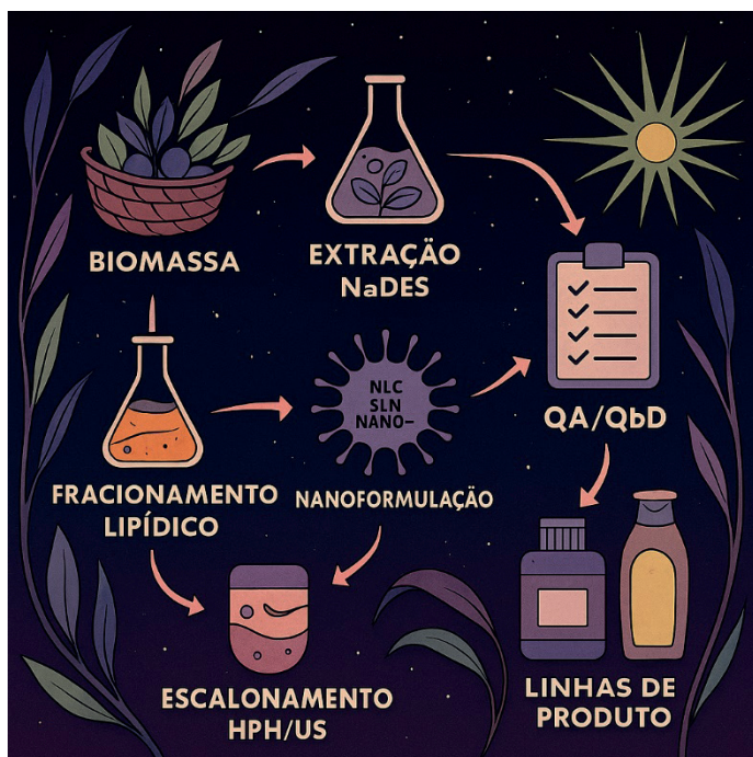
Figura 3: Fluxo integrado da plataforma bioeconômica: biomassa → extração com NaDES → fracionamento lipídico → nanoformulação (NLC/SLN/nanoemulsão) → QA/QbD → escalonamento (HPH/US) → linhas de produto. QA, garantia da qualidade, assegura que o produto atenda padrões de segurança e desempenho. QbD, quality by design, é o planejamento do produto e do processo com base em ciência e avaliação de risco, definindo atributos críticos de qualidade e parâmetros de processo para resultados reprodutíveis e escaláveis.
