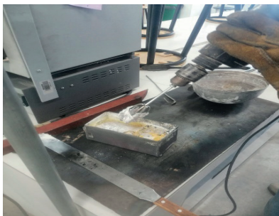
Figura 4. Fotografía mostrando la agitación mecánica durante la obtención de las aleaciones maestras.
