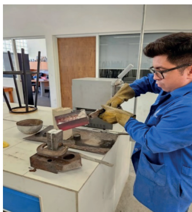
Figura 5. Fusión de aluminio 6061T6 Modificado con aleación maestra.
