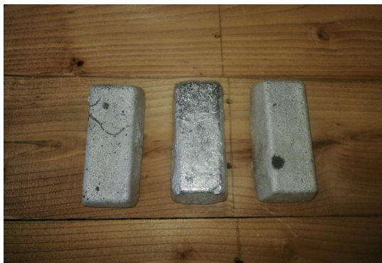
Figura 1 y 2. Fotografía mostrando la fusión de latas de aluminio en horno de piso y la obtención de lingotes para el estudio establecido.
