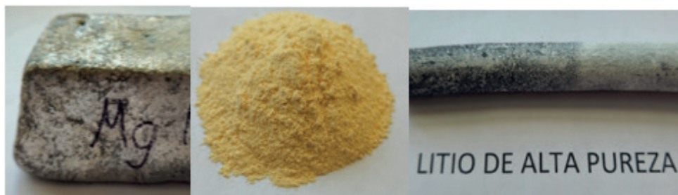
Figura 3. Fotografía mostrando el magnesio, oxido de cerio y el litio utilizados para la elaboración de las aleaciones maestras Al-Mg-Ce y Al-Li.
