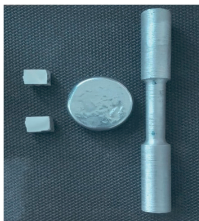
Figura 6. Representación de probetas obtenidas para realizar la caracterización.
