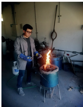
Figura 1 y 2. Fotografía mostrando la fusión de latas de aluminio en horno de piso y la obtención de lingotes para el estudio establecido.
