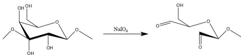
Figura 19. Esquema de reação da modificação da goma do cajueiro por oxidação utilizando periodato de sódio como agente oxidante, resultando em um produto mais reativo devido à formação de grupos aldeídos.
