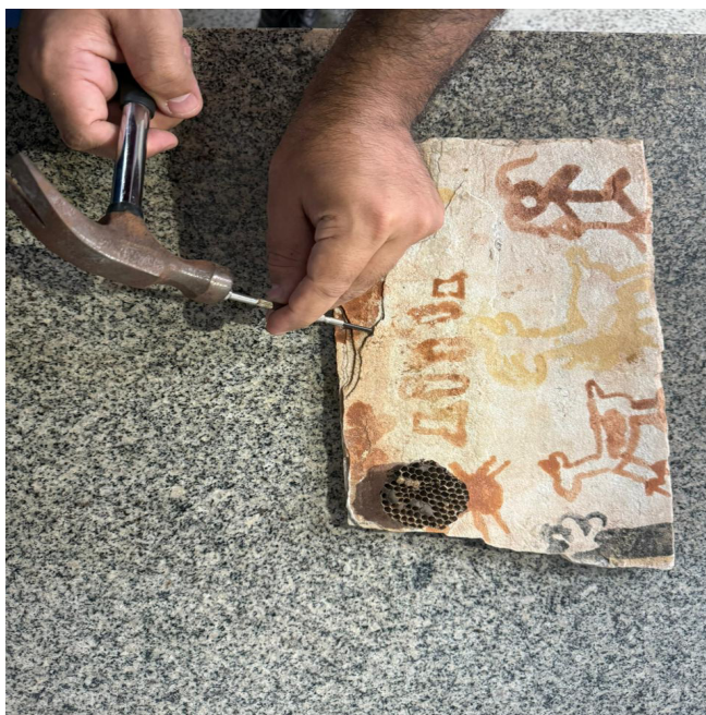
Figura 9: Suporte rochoso pintado com degradação simulada por deslocamento.
