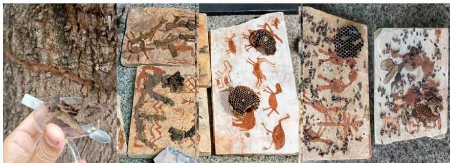
Figura 6: Preparação do suporte pintado, com degradação intencional simulando os danos causados por insetos construtores e dejetos de roedores.
