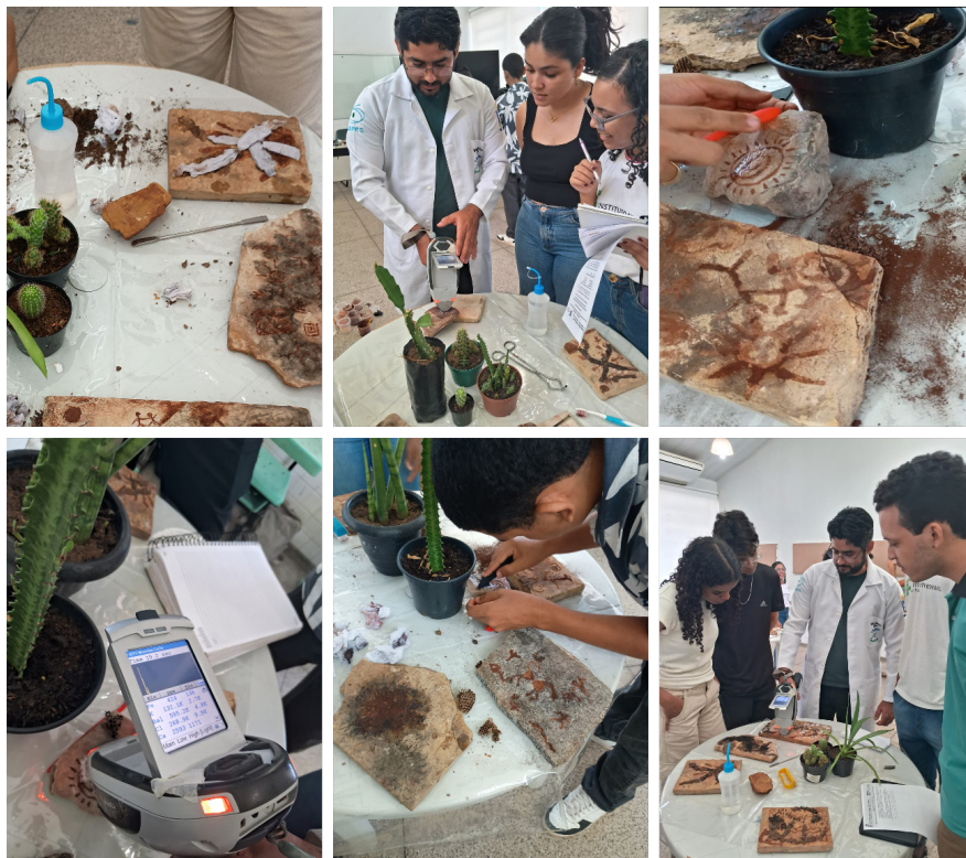
Figura 13: Etapa de identificação dos sais por meio de pFRX e remoção de eflorescência salina.
