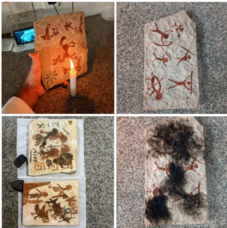
Figura 7: Suporte com degradação simulada por fuligem (acúmulo de resíduos) e carvão vegetal (pichações).
