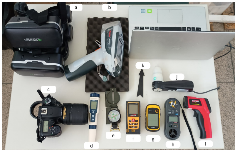
Figura 10: Materiais utilizados na etapa de conservação dos sítios simulados, Óculos 3D (a), Espectroscopia de fluorescência de raios-X portátil (pFRX) (b), Câmera digital(c), pHmetro Portátil (d), bússola (e), trena digital (f), GPS (g), anemômetro digital (h), termômetro (i), microscópio USB (j), seta de norte (k).
