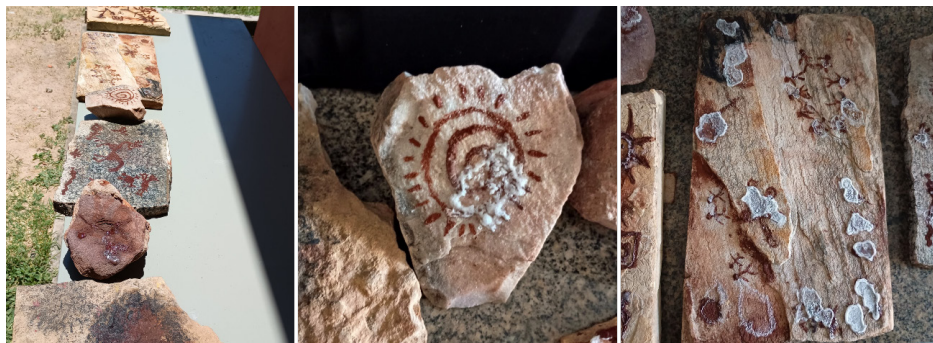
Figura 8: Suporte com degradação simulada por eflorescência salina.
